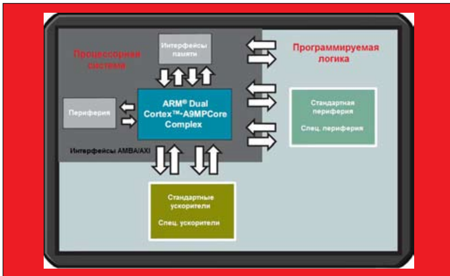
Рис. 5. Структура ядра ARM и его взаимодействие с периферийными устройствами и программируемыми ресурсами ПЛИС
